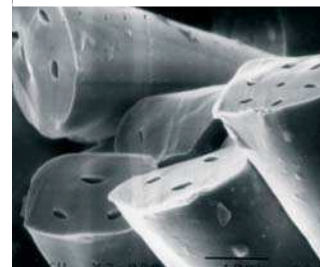
Vue au MEB de fibres synthétiques creuses. ©IFTH
