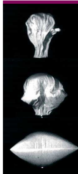
Test de visualisation du comportement des airbags. © T.Stegmaier - ITV Denkendorf
