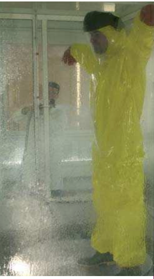
Test d'étanchéité d'une combinaison de protection. ©IFTH
