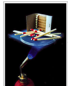
L'Aerogel è un ottimo isolante termico
