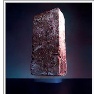
Un mattone di 2,5 kg sostenuto da un blocco di aerogel che pesa solo 2 grammi.
